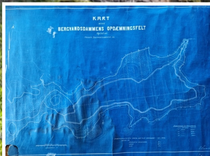
Boman-dammen økte kapasiteten fra ca. 10.000 til 320.000m 3 vann (NB: Bedre bilde kan tas av original på brukskontoret, Andorsrud)
