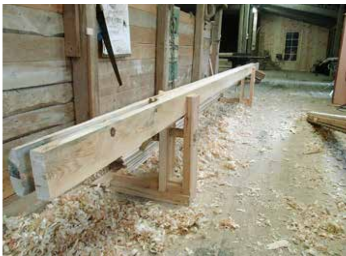
Bilde av en føibenk, også kalt skottbenk og rettbenk. Brukes sammen med høvlene under til å lage gulvbord helt rette. Foto: Magnus Wammen.
