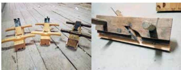
Okshøvler til å lage not og fjær og rettkant og okshøvel til å lage not. Foto: Magnus Wammen.
